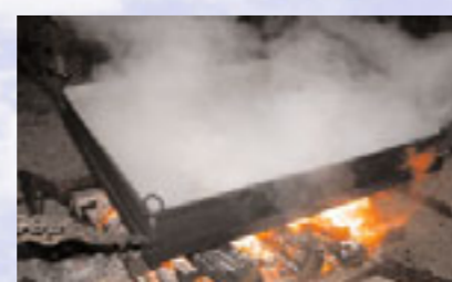
Beim Schausieden wird heute die Sole in einer großen rechteckigen Pfanne erhitzt.
