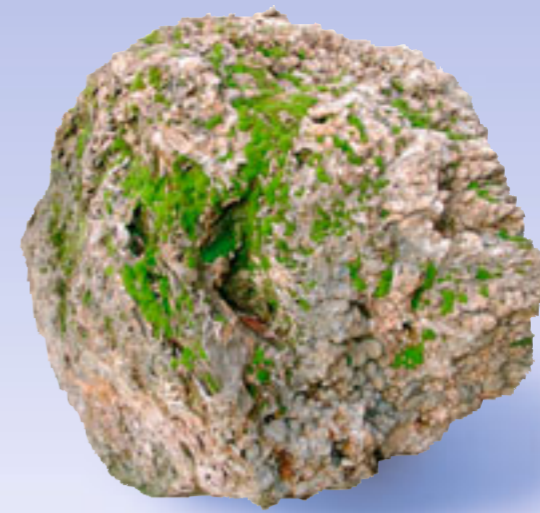
Rechts: Dornstein entstand im Gradierwerk durch Ablagerungen der tropfenden Sole am Schwarzdorn (Mariengrotte, wenige Meter oberhalb von Burg und Kirche). Oben: Gradierstein bildete sich durch das Absetzen von Ablagerungen in mit Sole gefüllten Holzkästen (mehrere Blöcke vor dem Museum).
